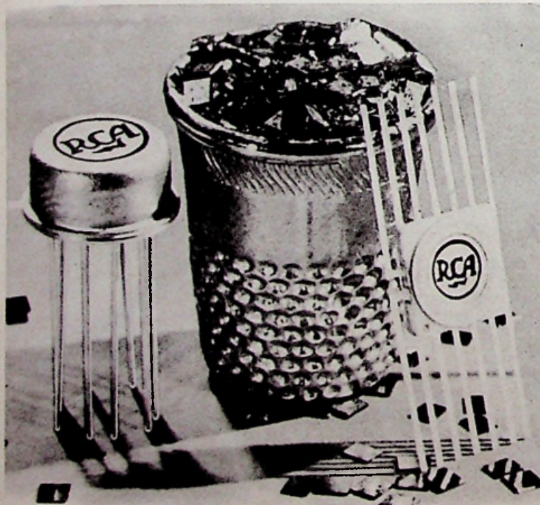
Vingerhoed gevuld met reeds gescheiden IC's. Een TO-5 en een „flat-pack"-uitvoering. (RCA)
